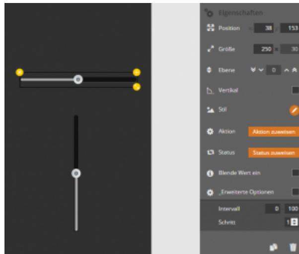
Dem Slider kann im Eigenschaften-Menü rechts eine Aktion und/oder ein Status zugewiesen werden. Den Schieberegel kann man auch vertikal ausrichten, dazu muss jedoch ein Haken im Eigenschaften-Menü gesetzt werden. Auch die Anzeige der Werte ist optional und kann durch Setzen des entsprechenden Hakens aktiviert werden. Länge und Stil sind ebenfalls veränderbar.
