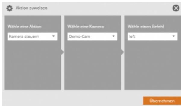
Beim Drücken der Taste wird dann die zugewiesene Aktion (z.B. Linksschwenken der Kamera) ausgelöst.
