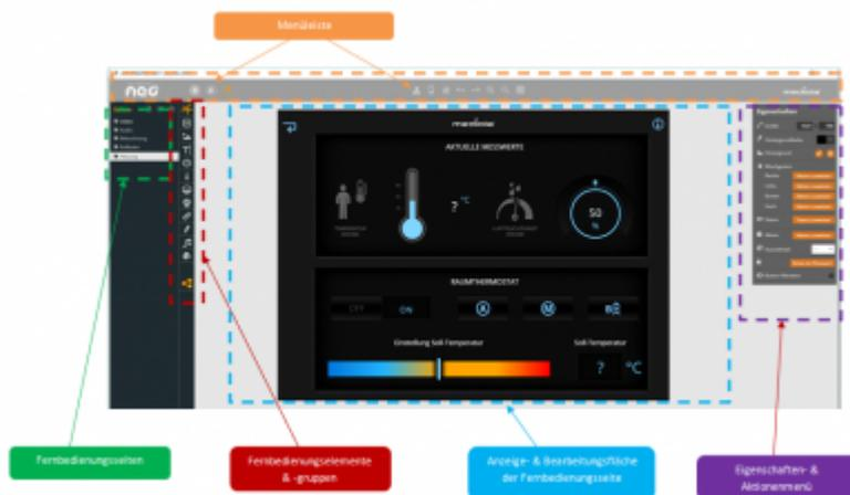
In der Bearbeitungsfläche (in der Mitte des Bildes) wird die jeweils links selektierte Fernbedienungsseite der geöffneten Fernbedienungsdatei angezeigt und kann bearbeitet werden.
