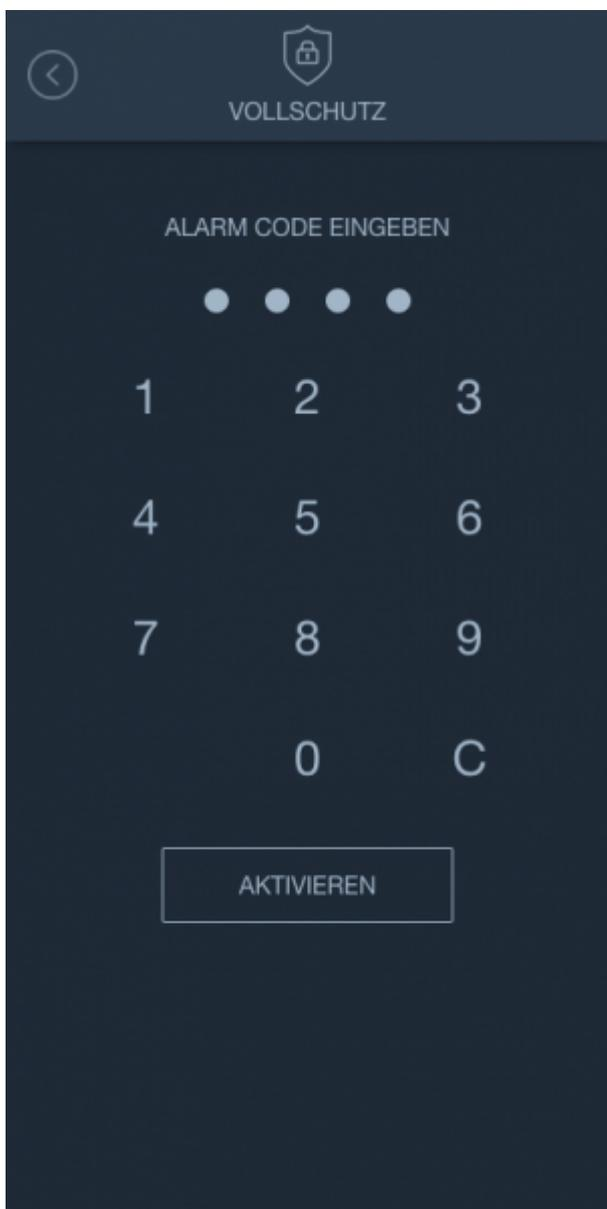
Wird der Alarm aktiviert, wird das Gateway gesperrt. In diesem Zustand ist es nicht möglich, Änderungen am System vorzunehmen. Dies dient der Manipulationssicherheit am System und ist zu erkennen am Gateway-gesperrt-Icon auf dem Dashboard.
