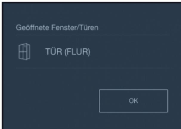
Sind alle Fenster und Türen geschlossen, kann der Alarm durch die PIN-Eingabe aktiviert werden. Wurde eine Aktivierungsverzögerung eingestellt, wird diese jetzt ausgeführt, ansonsten wird der Alarm direkt aktiviert.
