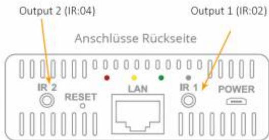
Um IR Kommandos über externe IR-Dioden aussenden zu können, muß bei dem jeweiligen Gerät bei „IR senden über“ eine dieser beiden Output-Optionen gewählt und die Diode in die entsprechende Buchse gesteckt werden.
