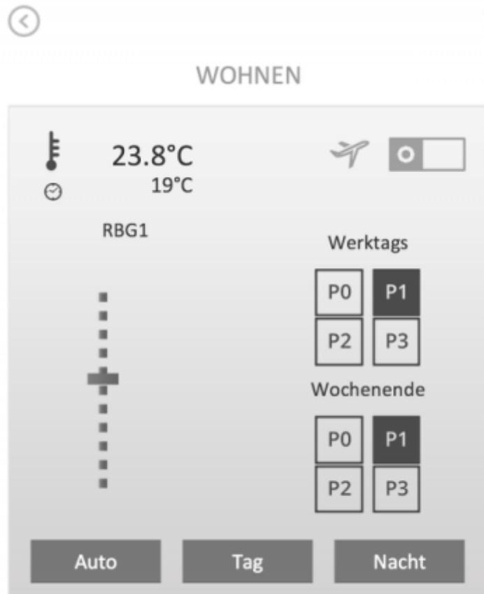
**Wichtiger Hinweis :** Die IQONTROL App dient lediglich zum komfortablen Steuern der Alpha 2. Einstellungen wie Urlaubsmodus oder das Konfigurieren der Programme muss über die Weboberfläche der Alpha 2 konfiguriert werden. Ein Link zu der Weboberfläche befindet sich in den Einstellungen des Alpha2 Gateways. Zudem kann die Alpha 2 nicht über den Taskmanager des AIO Gateway gesteuert werden.
