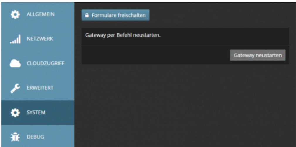
Unter System kann das Gateway per Befehl neu gestartet werden.
