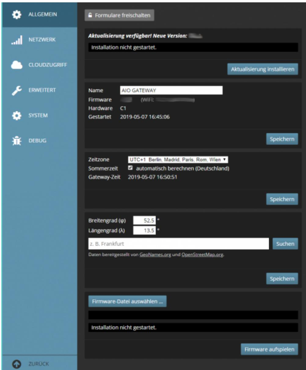
Hier kann man den Namen des Gateways, den Standort und die Zeitzone ändern, sowie die Firmware aktualisieren oder eine Firmware-Datei direkt aufspielen. Außerdem erhält man dort Auskunft über die aktuelle Firmwareversion des Gateways, welche dort manuell aktualisiert werden kann.
