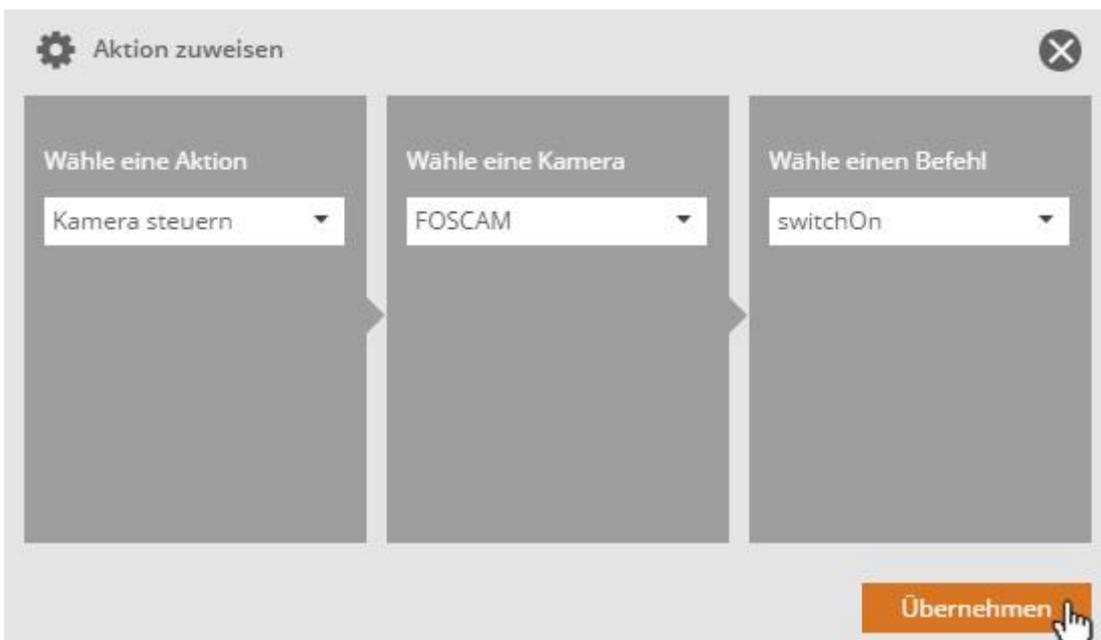
... und weisen für das **Einschalten** Ihrer Foscam IP dem **Button** den **Befehl switchOn** zu. Zum **Ausschalten** verwenden Sie den Befehl **switchOff**.
